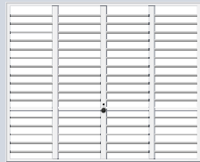
Motív 904 Kruhový profil (Ø 12 mm, odstup 100 mm)
