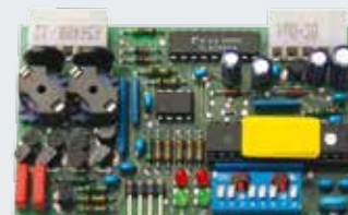
Vyhodnocovač indukčných slučiek Nástrčná platina 1-kanálová alebo 2-kanálová, vhodná pre 2 oddelené indukčné slučky, dodanie bez slučkového kábla
