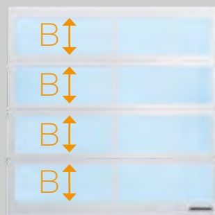
Vyhotovenie brány s rovnomerne rozdelenými presklenými poliami
